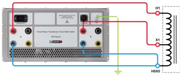
Connexion de TRT à un autotransformateur monophasé
