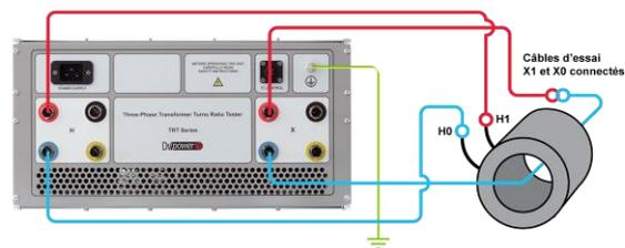
Connexion de TRT à un transformateur de courant démonté
