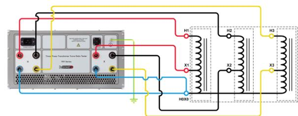
Connexion de TRT à un autotransformateur triphasé
