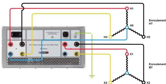
Connexion de TRT à un transformateur triphasé
